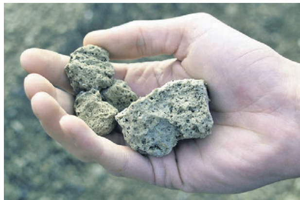
Vom Abbau bis zum Recycling: Leichtbeton-Mauersteine aus mineralischem Bimsstein weisen eine sehr gute Ökobilanz auf. Foto: djd/Bundesverband Leichtbeton
